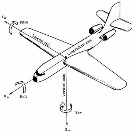
L'algorithme DCM (contraction de Direct Cosine Matrix) permet de déterminer à tout moment la position et l'orientation d'un objet dans un repère donné. [à faire]
